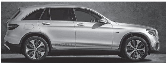
Рис. 6. Mercedes-Benz GLC F-Cell — серийный легковой автомобиль на водородных топливных элементах.
