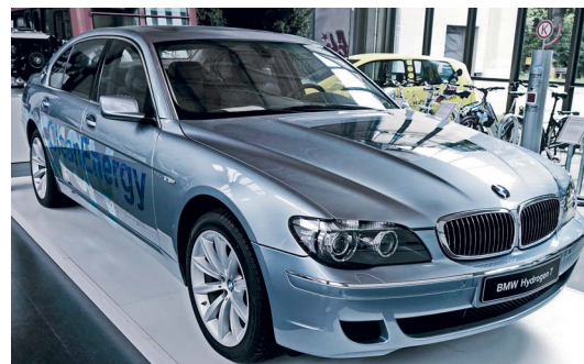
Рис. 4. Битопливный автомобиль BMW Hydrogen 7 (двигатель может работать в двух режимах: на бензине или водороде).
