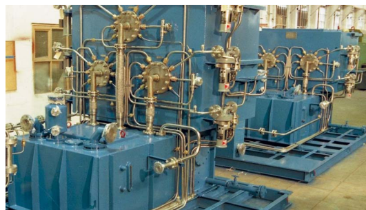
Рис. 3. Установка ожижения водорода НПО «Гелиймаш», электрическая мощность — 210 кВт.
